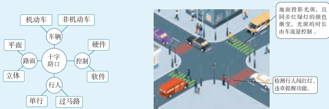
图 3-1 交通路口安全高效信号灯装置示意图和效果图
