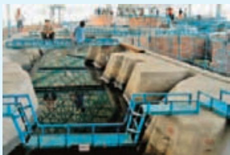
图3-14 工作人员在模型黄河小浪底库区断面进行含沙垂直测量
