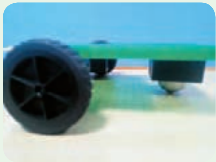
图1-20 组装万向轮后移动平台的侧面
