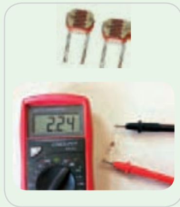
图3-14 光敏电阻的阻值测量
