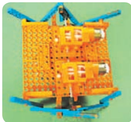
电动机齿轮箱与机身的安装
