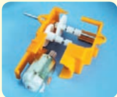
图2-9 齿轮箱的安装分解图
