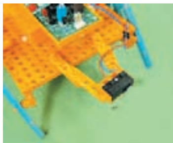
爬行机器人中的接触传感器
