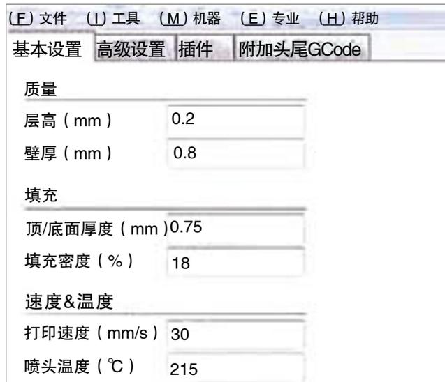
图 2-14 三维打印机基本参数
