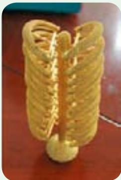
图 4-3 三维打印的蜡模 图 4-4 铸造出的首饰
