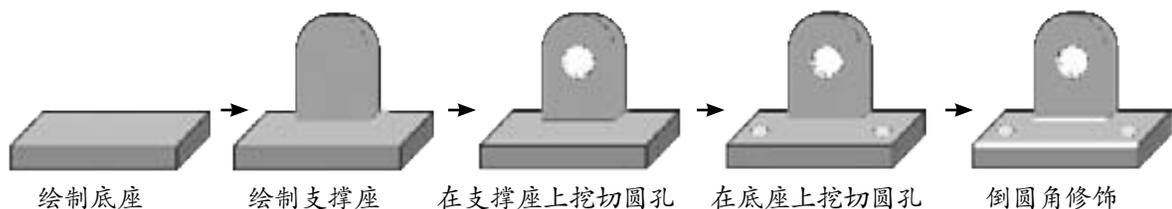
图 3-8 三维模型绘制过程
