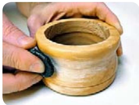
图4-16 砂纸打磨
