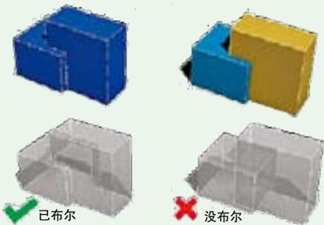
图 2-10 三维打印不能有重合、叠加
