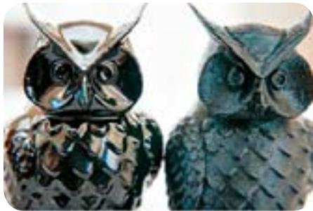
图4-17 蒸汽平滑处理效果
