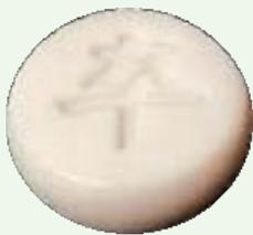
图 1-6 光固化三维打印的象棋子
