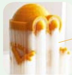
图 2-6 悬空结构的支撑
