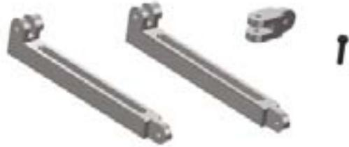
图 4-14 手机高度调节组件三维效果图
