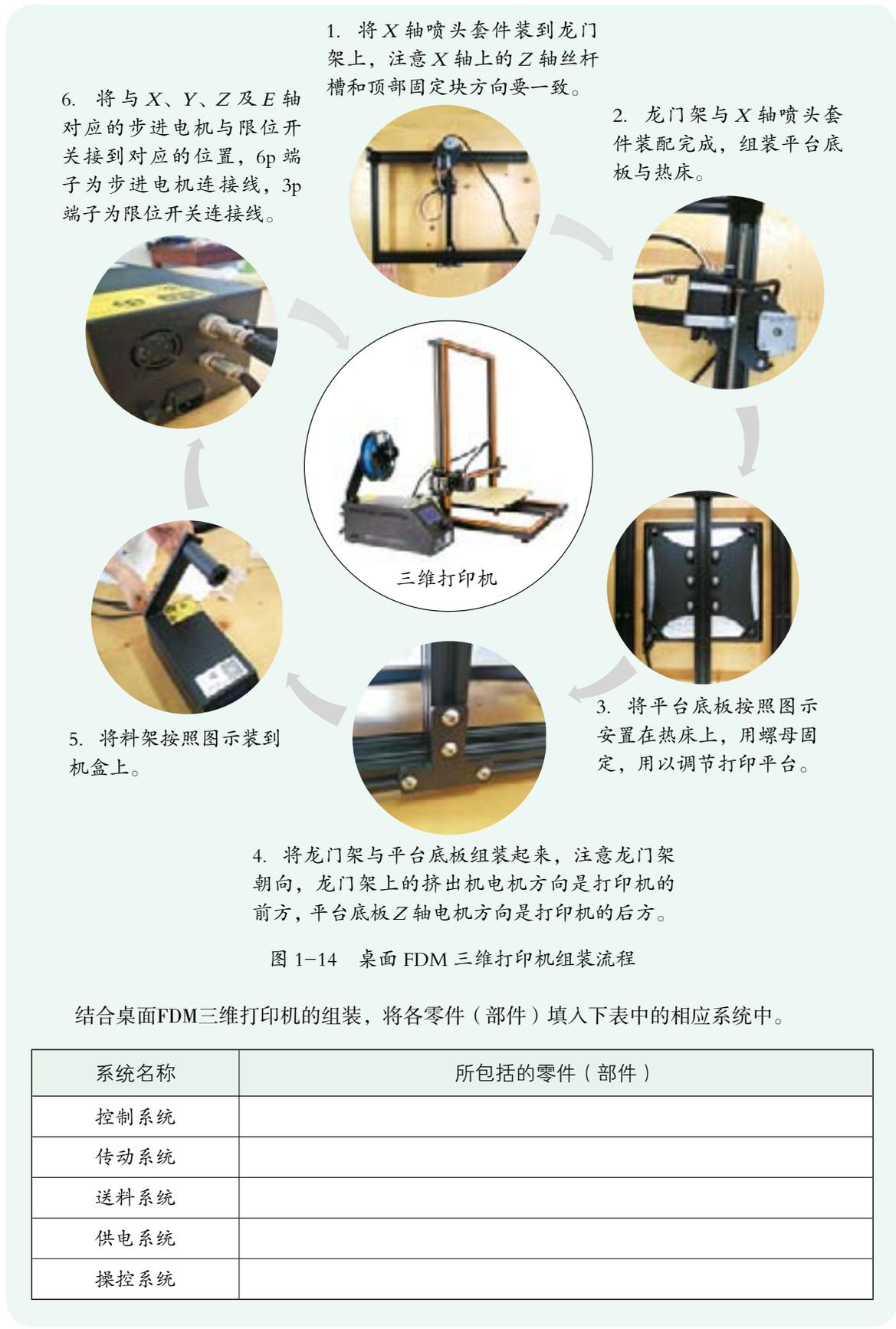
图 1-14 桌面 FDM 三维打印机组装流程
