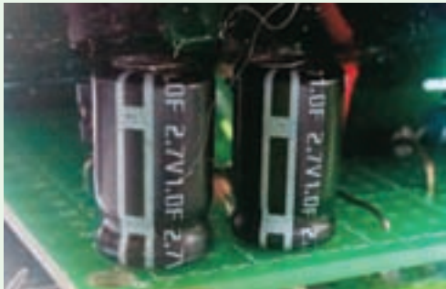
图 3-15 安装、焊接法拉电容器
