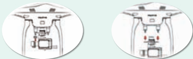
图 4-37 拆卸无人机相机云台
