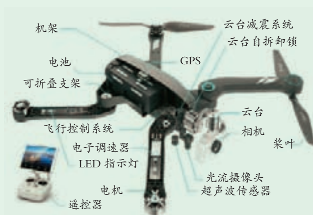
图 4-21 多旋翼飞行器结构
