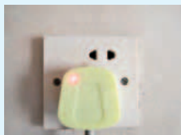
图 3-20 发光二极管的指示作用
