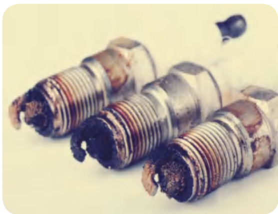
图4-32 严重腐蚀的火花塞
