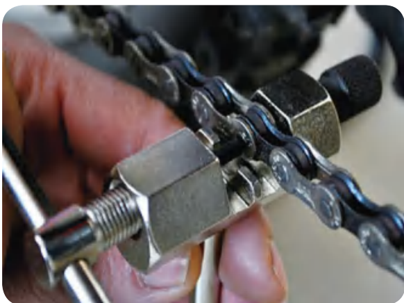
图4-42 截链器拆分链条
