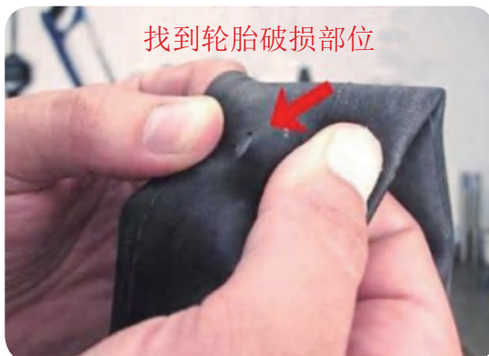
图4-49 找出破损部位
