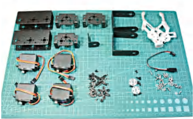
图2-46 机器人手臂配件
