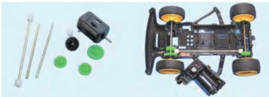
图2-16 四驱车模型的齿轮传动装置
