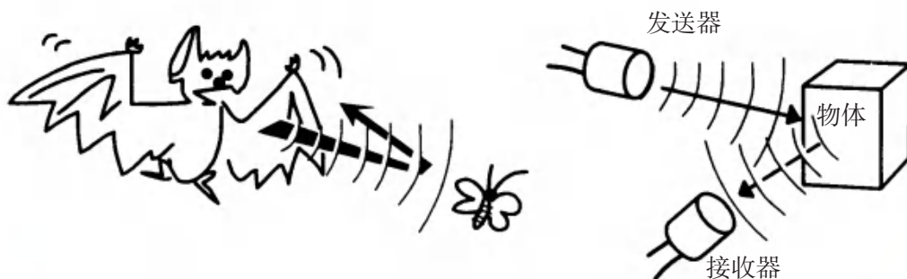
图4-12 超声波传感器原理
