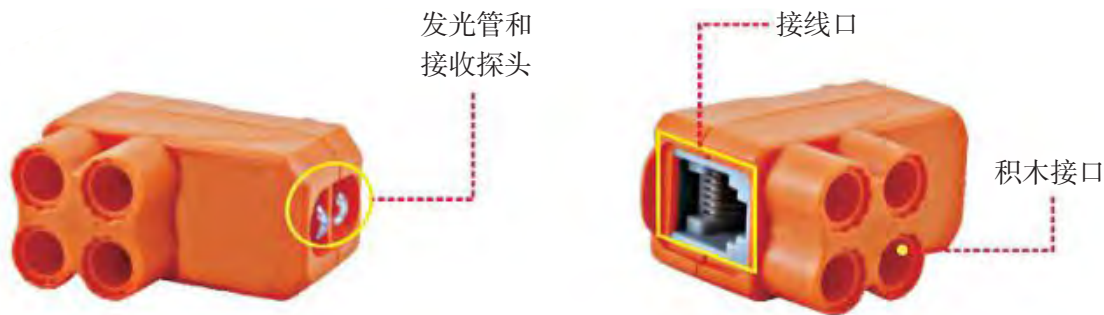
图4-20 反射式光电传感器应用模块
