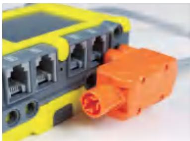
图4-17 触碰传感器松开状态
