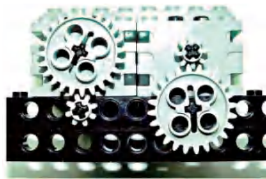
图2-9 机器人中的齿轮传动
