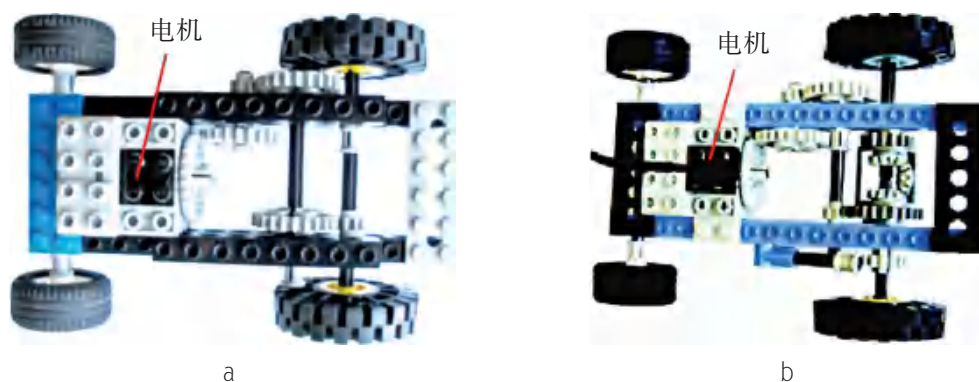
图2-31 齿轮传动的四轮形式
