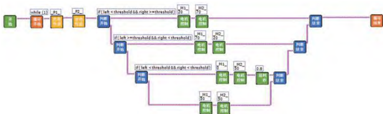
图4-46 T形路口路径判断图形化程序
