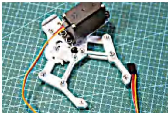
图2-53 安装手爪控制舵机
