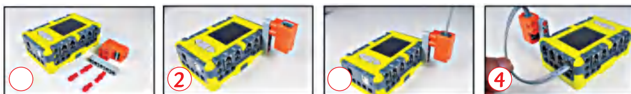
图4-21 光电传感器应用模块与控制器模块的连接示意
