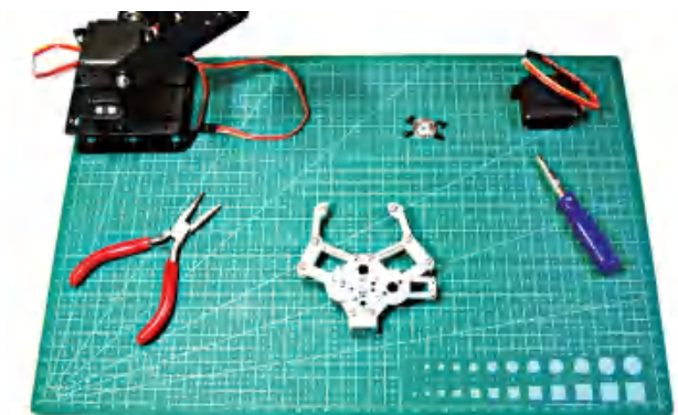
图2-52 组装机械手爪
