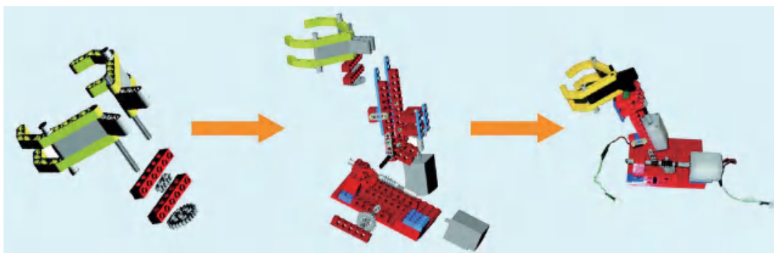
图2-43 机器人手爪的拼装过程
