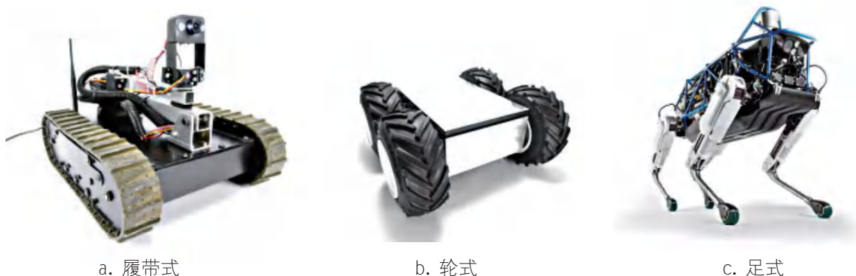
图2-30 机器人移动机构的主要方式
