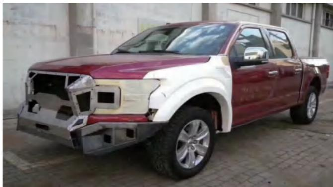
图4-48 三维打印制作汽车翼子板
