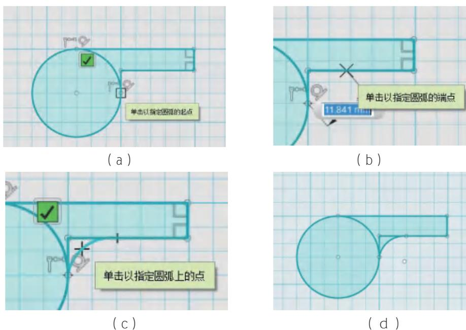
图4-5 用“三点圆弧”工具绘制部分哨身草图
