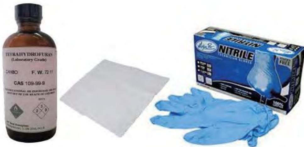
图4-45 PLA模型的溶剂抛光工具
