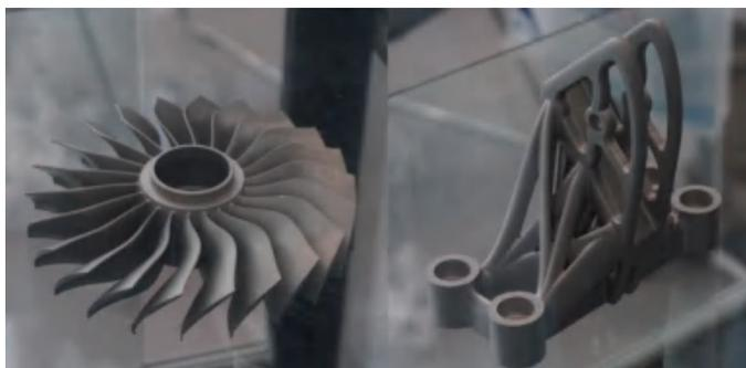
图2-4 选择性激光烧结打印的产品
