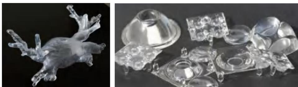
图2-10 透明光敏树脂打印的产品
