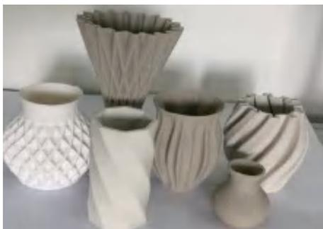
图2-11 陶瓷材料打印的产品
