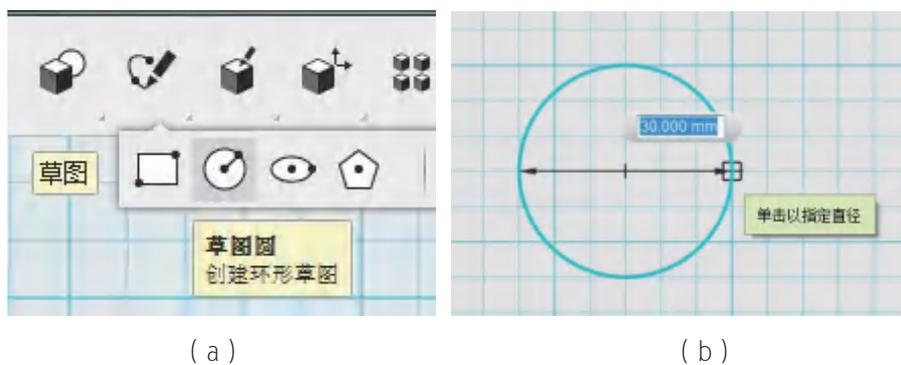
图4-3 用“草图圆”工具绘制部分哨身草图
