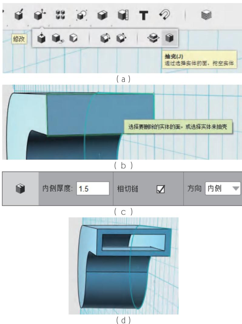
图4-8 构建哨子中空结构
