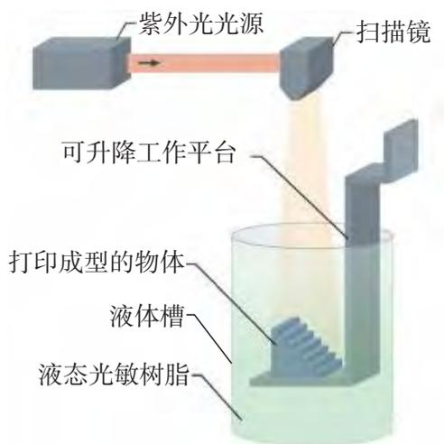
图2-1 光固化立体成型原理示意
