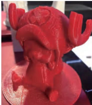
图2-6 熔融沉积成型打印的产品
