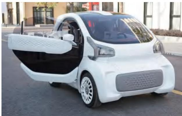
图1-4 三维打印的汽车
