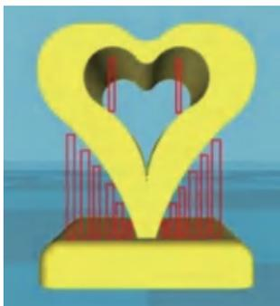
图3-36 接触平台支撑
