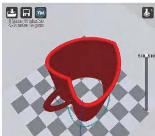
图3-42 分层浏览模式下的切片模型
