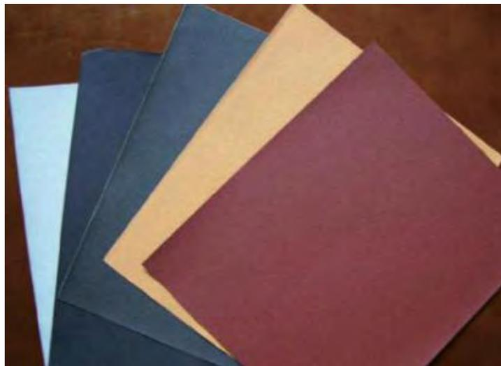
图4-44 不同型号的水砂纸
