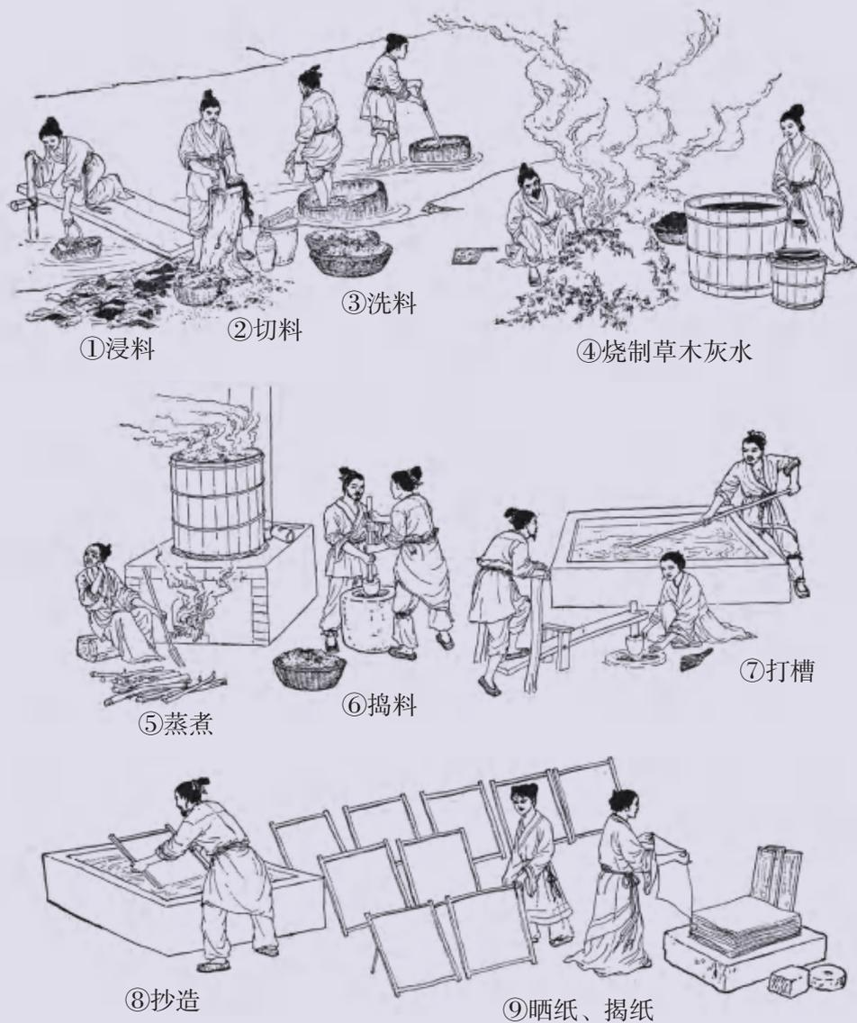
图2-5 汉代造麻纸工艺流程
