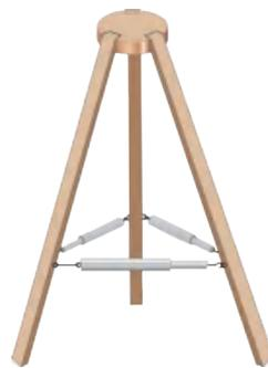
图1-67 加了弹簧测力计的三脚架
