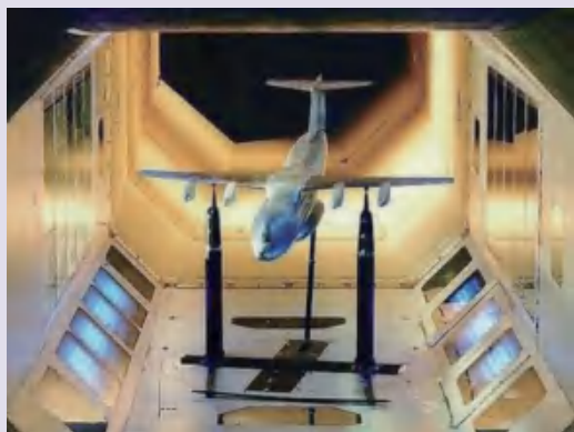
图4-17 风洞试验中的飞机模型
