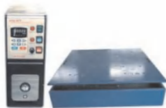
环境适应性试验：低频振动试验机
