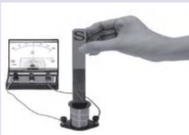
图2-2 电磁感应实验
