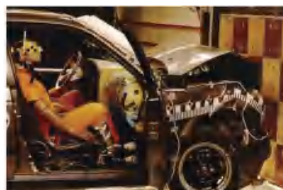
破坏性试验：汽车碰撞试验
