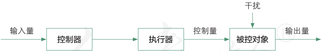
图4-17 开环控制系统的干扰情况
