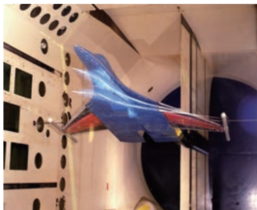
图2-16 飞机风洞试验
