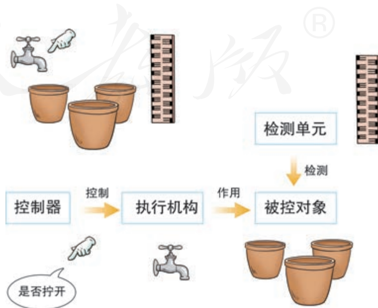
图4-6 水缸水位控制系统组成部分
