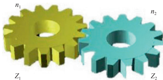
图1-44 齿轮传动比的计算
