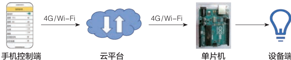
图4-3 室内智能灯光控制系统示意图
