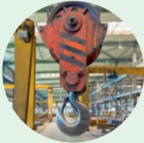
图 4-3 起重机吊钩实例
