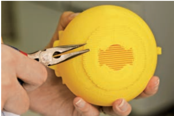
图 1-12 去除打印支撑
