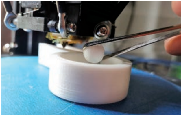
图 4-5 暂停打印并放入弹子
