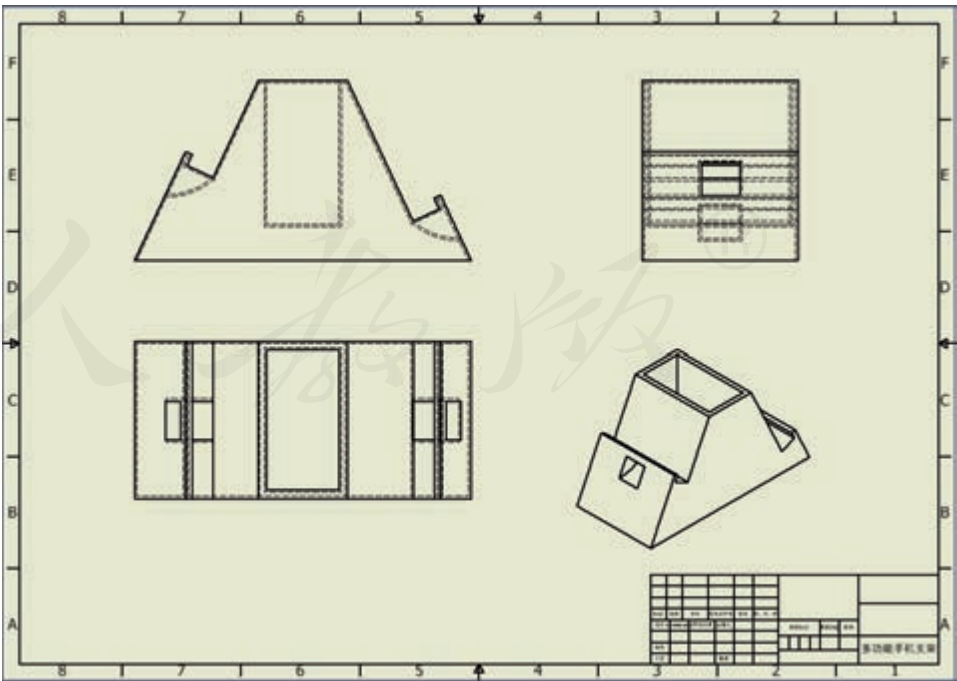
图3-43 多功能手机支架基础视图
