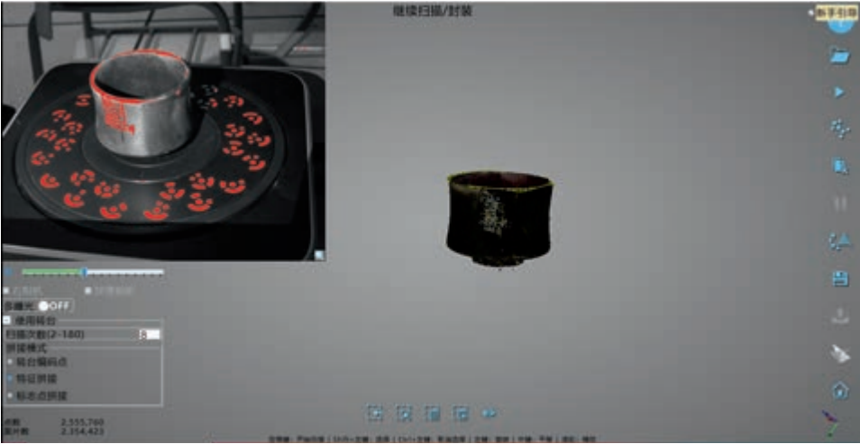
图4-19 陶杯点云拼接处理
