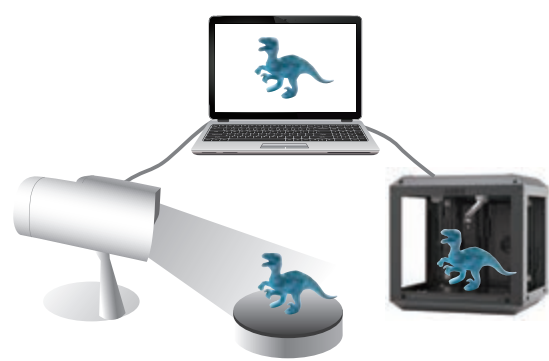
图1-10 三维扫描仪扫描获取物体信息示意图
