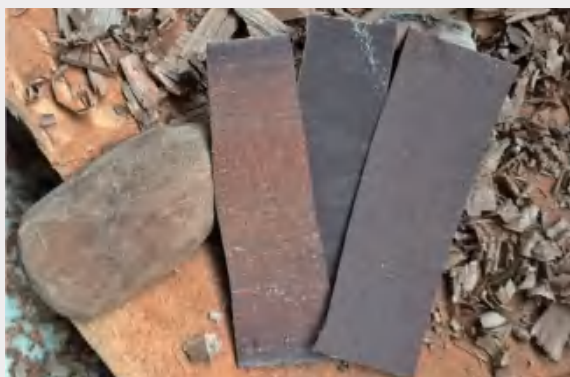
⑤ 勺子雕刻好后，用砂纸打磨勺子的表面，先用最粗糙的砂纸打磨，然后换成较细的砂纸打磨，直到将勺子打磨得非常光滑。
