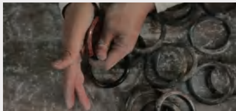
⑦ 用棉花混和推光粉进行揩清和推光，反复操作，直至手镯漆面光亮。
