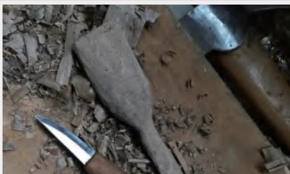
③ 用小刀对劈好的木材继续进行修整，修出勺子外形。
