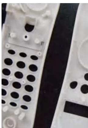
▲ 运用真空复模技术成型的模型零件 〔以硅胶为模具，以PU（聚氨酯）为材料〕
