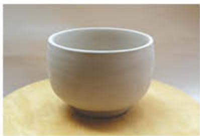
刚完成的坯体
