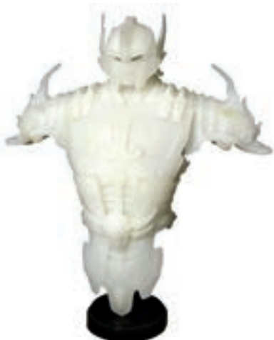
5. 通过快速成型机，打印出实体。
