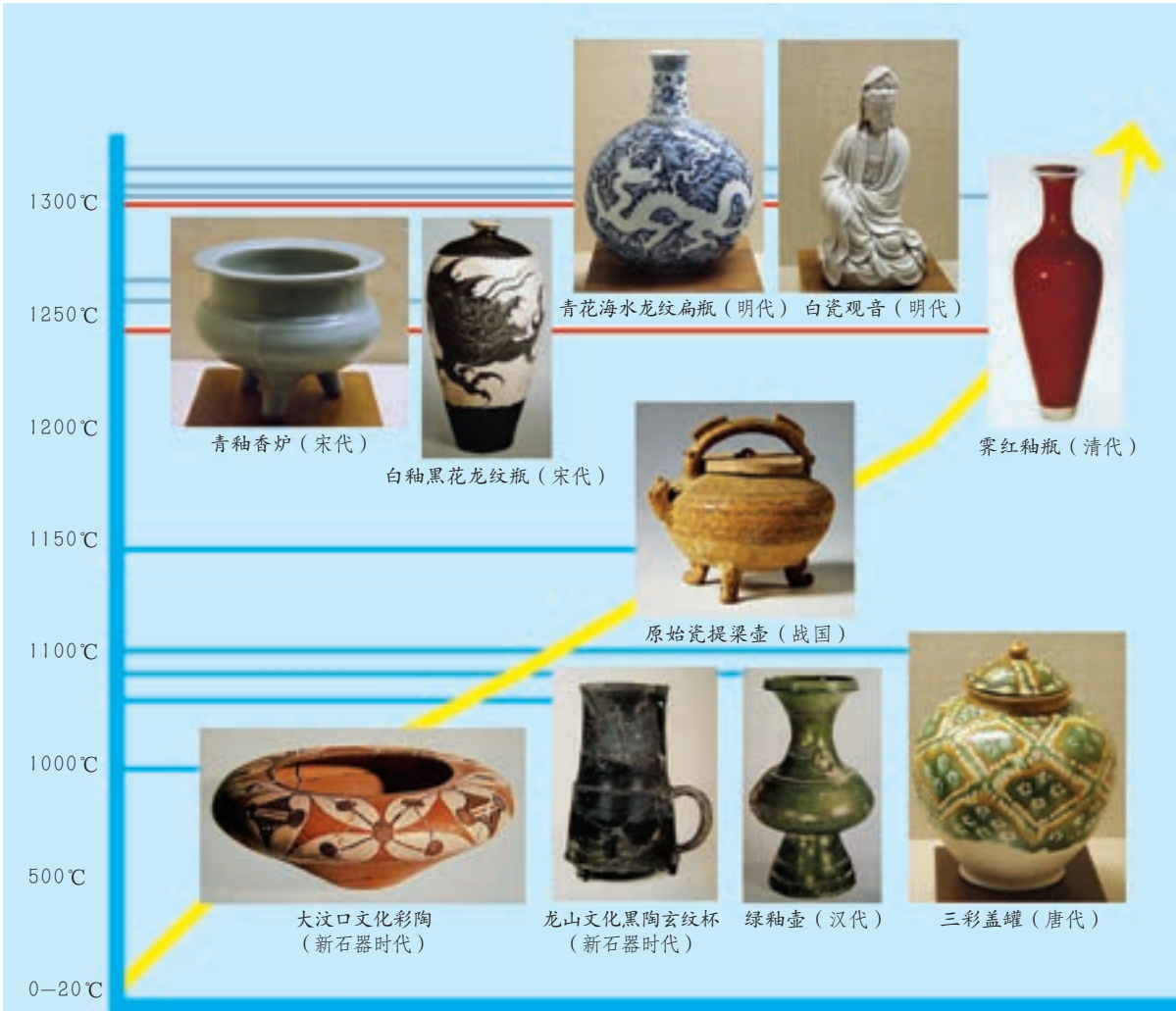
陶瓷烧制品种与温度关系图
