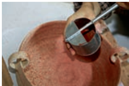
8. 等待坯体完全干燥，开始吹釉，然后入窑烧成。
