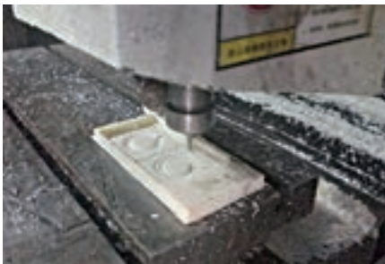
⑧ 产品模型的制作过程：研讨造型设计过程中遇到的问题，从模型中理解产品的设计意图，检验方案的合理性。
