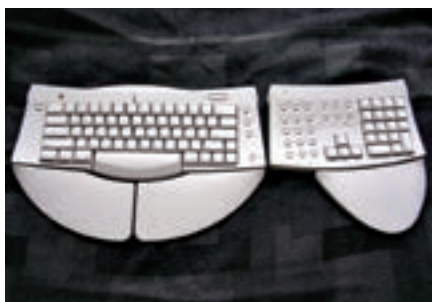
可调整键盘 文特设计公司（美国）1993年 键盘可随意调整宽度，考虑到不同人的手形、尺寸，巧妙而灵活地分开了左右手的控制区域，满足了产品的个性化需求。
