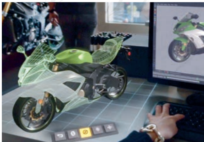
◇ 通过佩戴AR眼镜，配合3D建模软件，设计师可以通过混合现实技术把作品更改后的效果实时投射到模型上。
