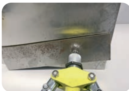
5. 将钉子插入两片金属板的钻孔中，压紧 6. 铆接完成。
