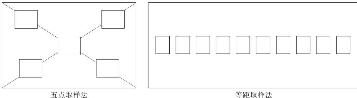
图 1-1-3 常用的取样方法示意图
