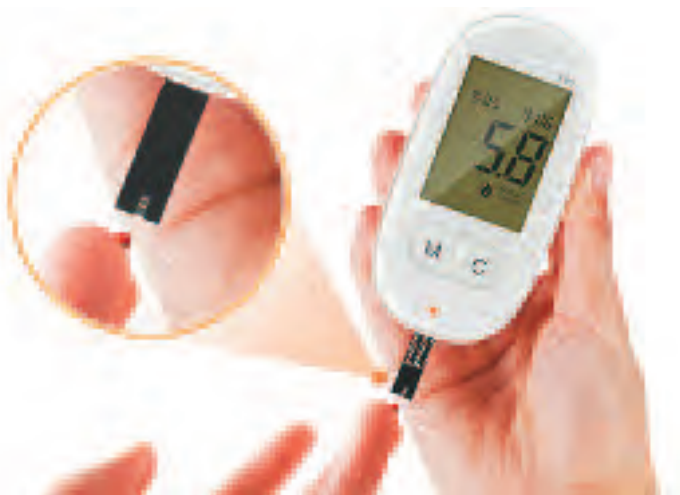
图 2-2-1 血糖仪及血糖测量的示意图
