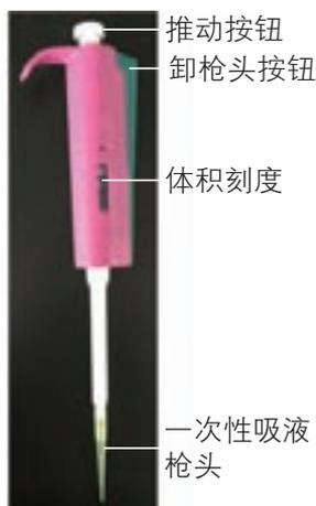
图4-13 微量移液器
