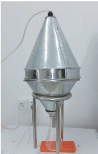
图2-3 干漏斗分离装置
