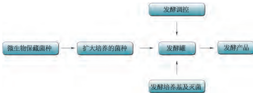
图 1-19 工业发酵流程示意图
