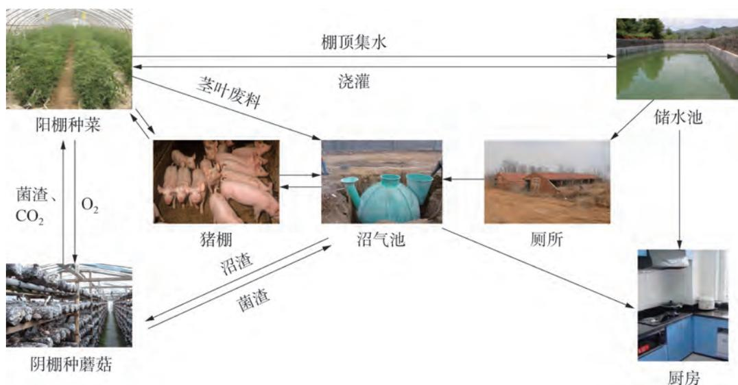
图 4-22 生态循环设施模式图
