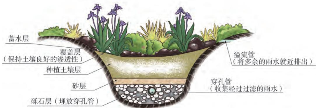
图 4-30 雨水花园结构示意图
