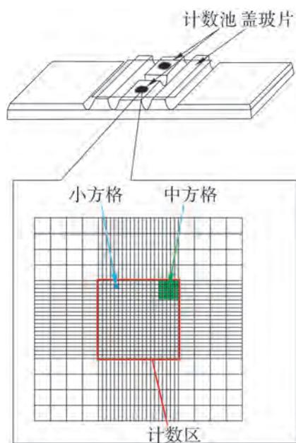
图 1-14 血细胞计数板构造示意图
