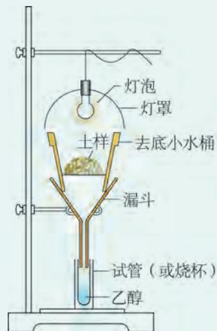
图 1-18 诱虫器的结构示意图
