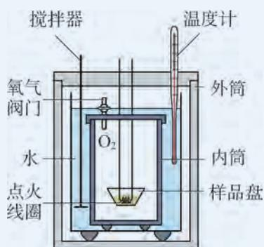
图 2-9 氧弹量热仪结构示意图
