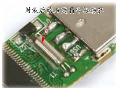
图4-7 USB闪存盘中的石英晶体振荡器
