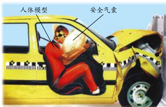
图 1-9 安全气囊的缓冲可减轻伤害
