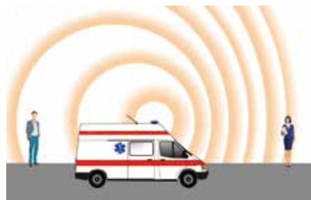
图 3-37 救护车驶过时听到的音调变化示意图
