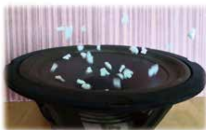
图 2-9 随扬声器纸盆振动而跳动的泡沫
