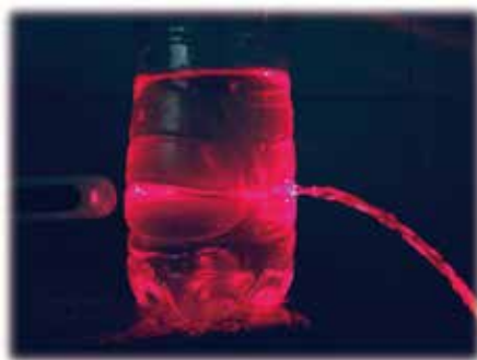
图 4-32 模拟光纤实验
