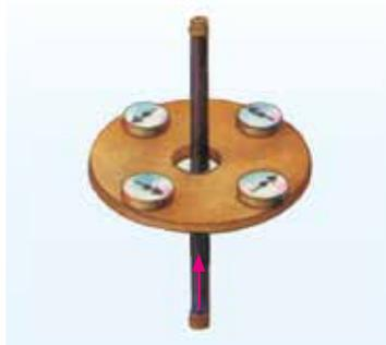
图 5-2 电流使磁针发生偏转
