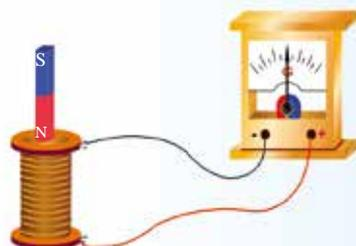
图 5-24 将磁铁插入或拔出螺线管的示意图
