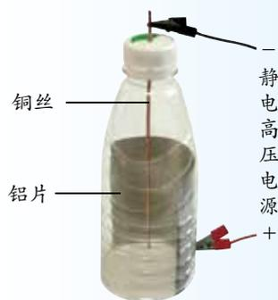
图 1-29 静电除尘模拟装置
