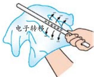
图1-7 用丝绸摩擦玻璃棒使其带电
