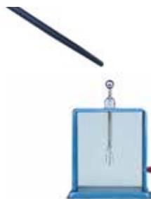
图1-3 将带电橡胶棒靠近验电器的金属球
