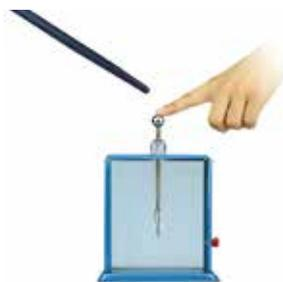
图1-4 用手接触验电器的金属球
