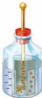
图2-22 莱顿瓶结构示意图
