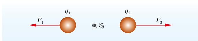
图 1-15 两正电荷相互作用的示意图
