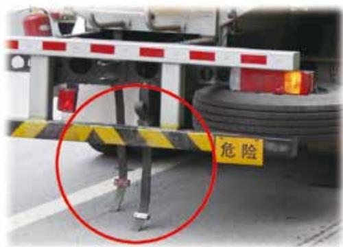
图1-35 油罐车车尾装有导电拖地带
