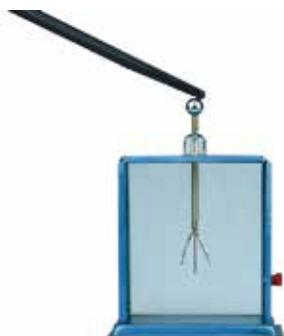
图 1-2 将带电橡胶棒与验电器接触
