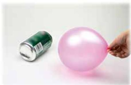
图 1-9 带电气球能使金属筒滚动
