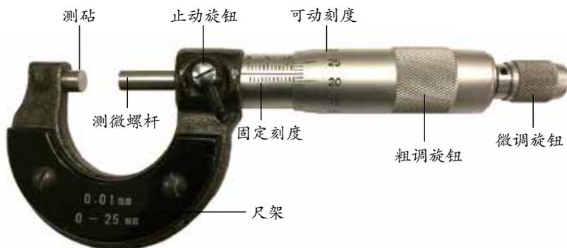
图 3-35 螺旋测微器的结构
