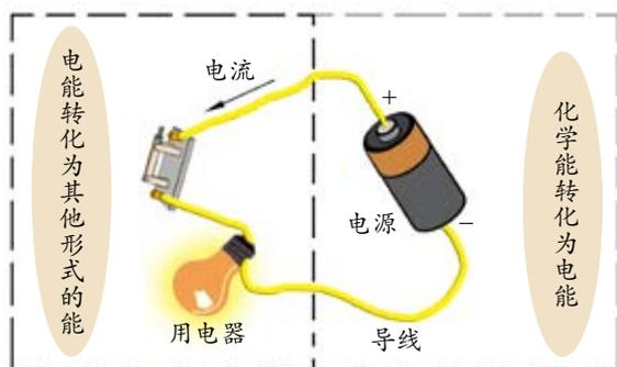
图 4-3 内、外电路中能量转化示意图
