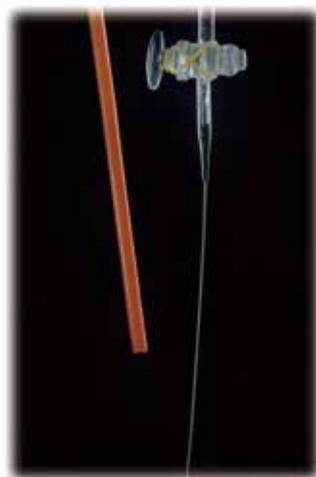
图 1-14 静电力可让细水流改变方向
