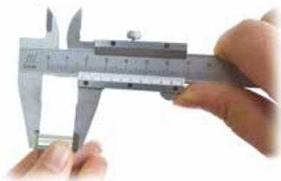
图 3-34 测量工件长度
