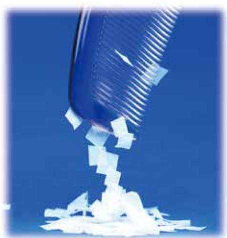
图 1-1 梳过头发的塑料梳可吸起细小纸屑
