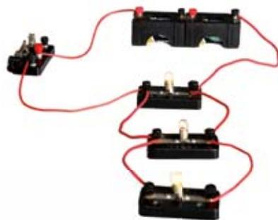
图 3-26 电路元件并联在电路中
