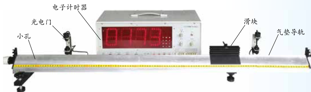
图 5-3 通过气垫导轨演示匀速直线运动
