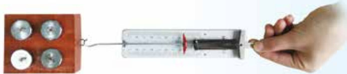
图 3-31 粗测最大静摩擦力
