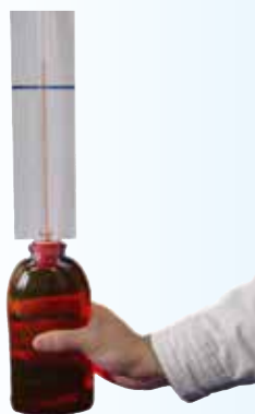
图 3-14 观察玻璃瓶的微小形变
