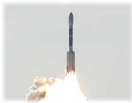
图 5-21 气体的反作用力使火箭升空
