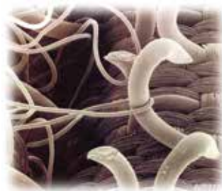
图 3-22 尼龙扣的显微照片
