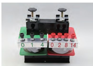
图 3-3-3 实验室用的可拆变压器
