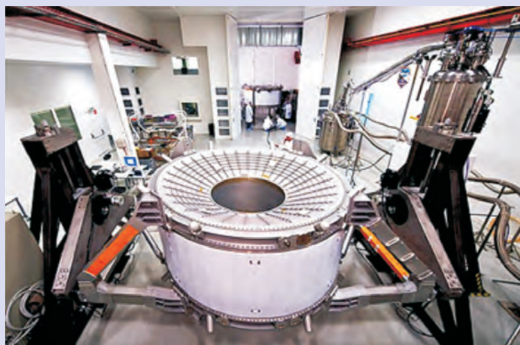
图 1-4-11 中国研制的阿尔法磁谱仪永磁体系统
