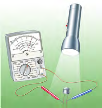
图 5-1-13 用多用电表测光敏电阻阻值的变化
