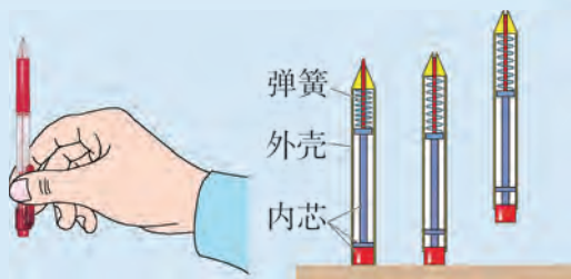
图 4-5-7 探究按压式圆珠笔内部弹簧弹性势能的变化
