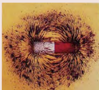
图 6-1-5 条形磁铁磁场中铁屑的分布情况图
