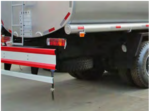
图 2-3-9 油罐车尾的铁链
