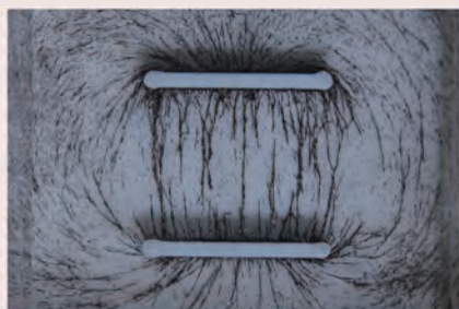
(a) 模拟带等量异种电荷的平行金属板的电场线 (b) 带等量异种电荷的平行金属板的电场线分布
