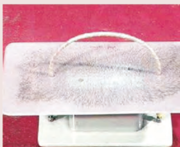
图 6-1-11 环形电流磁场 中铁屑的分布情况图
