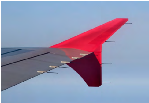
图 2-3-8 飞机上的“放电刷”
