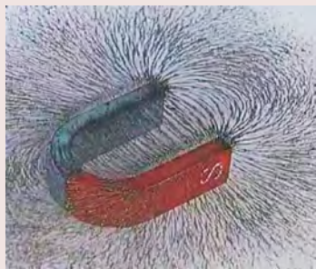
图 6-1-7 蹄形磁铁磁场中铁屑的分布情况图
