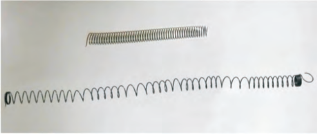
图 3-2-3 形变超过弹性限度的弹簧不能恢复原状
