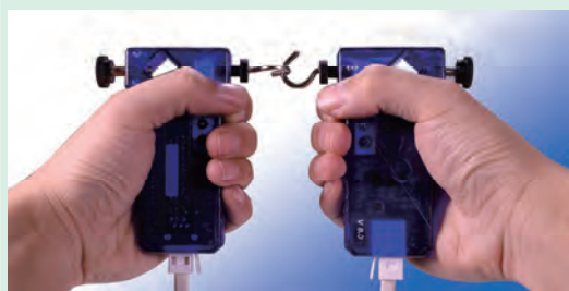
图 4-4-6 用力传感器显示作用力与反作用力
