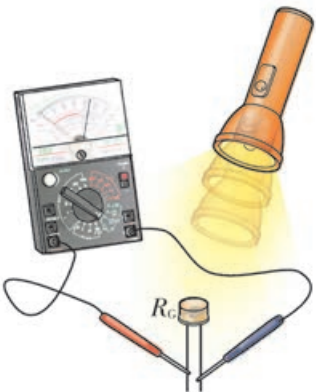
图 5-1-5 光敏电阻导电性实验装置图
