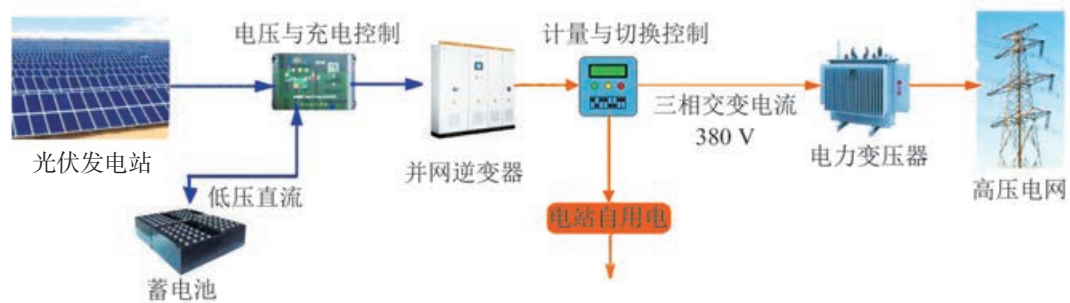
图 3-1-12 光伏发电站的发电、送电运行图
