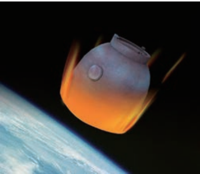
图 4-1-1 飞船返回舱返回地球通过大气层时，与空气剧烈摩擦，使其表面温度高达 2000℃
