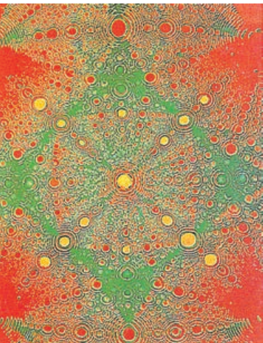
图 1-1-1 场离子显微镜 (FIM) 拍摄的图像显示了铂针顶端的原子(橘黄色)排列情况，这个图像放大了 20 万倍
