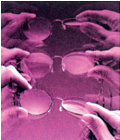
图 3-4-15 用弹性合金材料制成的眼镜架，被扭曲后仍会恢复原状
