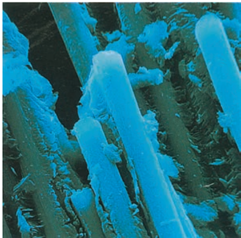
图 3-4-14 用碳纤维加固的塑料（此为显微镜照片）的质量是钢的 1/4，但强度是钢的 2 倍
