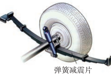
图 2-5-6 汽车底盘的弹簧减震片
