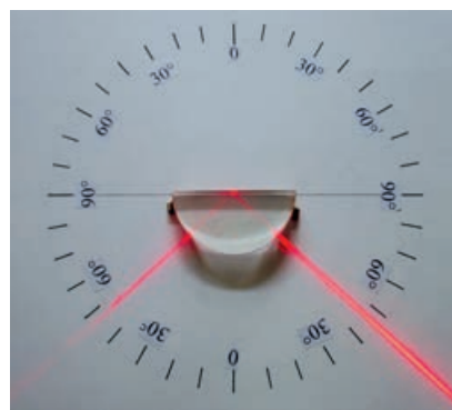
图 4-2-2 光的全反射实验
