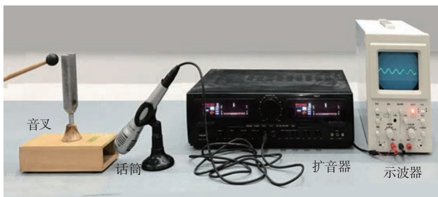
图 2-1-5 用示波器研究声振动
