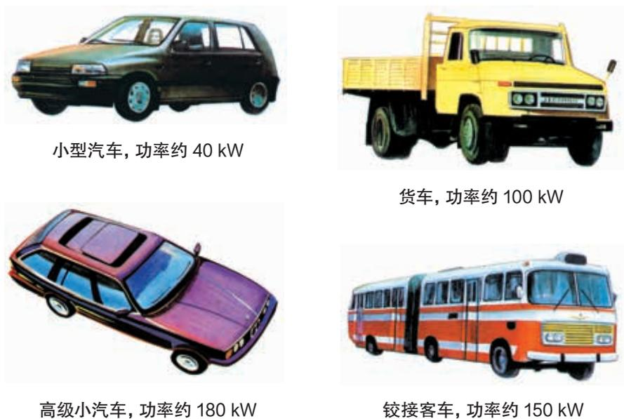
图 1-2-4 几种汽车发动机的平均功率
