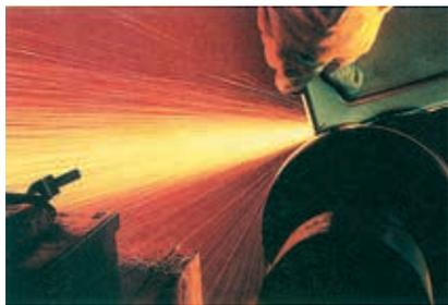
图 3-1-4 火花沿砂轮的切线方向飞出
