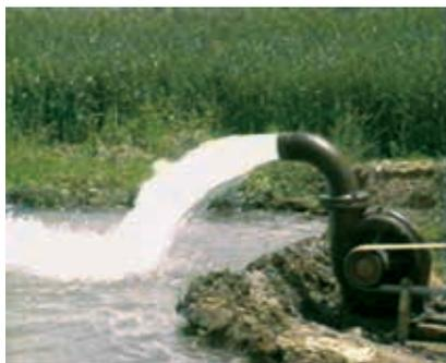
图 3-4-5 正在抽水的离心式水泵
