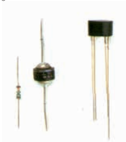
图 3-1-7 晶体二极管和它的符号
