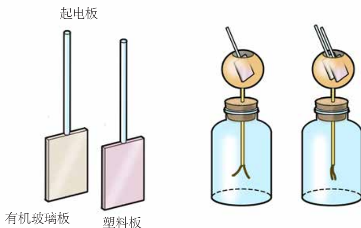
图 1-1-4 电荷守恒实验
