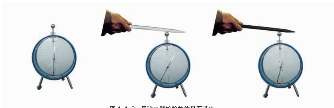
图 1-1-2 用验电器检验物体是否带电
