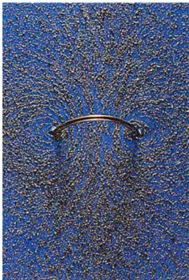
图 5-2-10 铁屑在环形电流磁场中的分布
