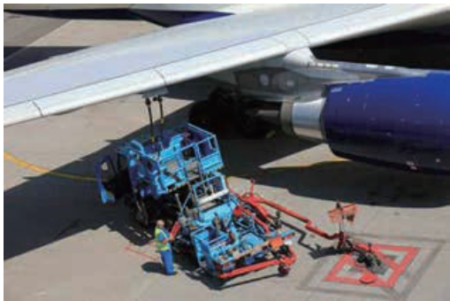
图 1-3-9 飞机加油车的接地装置
