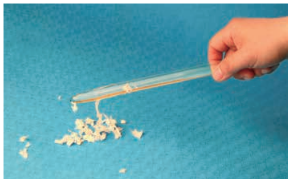
a 用丝绸摩擦过的玻璃棒吸引轻小物体
