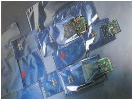
图 1-3-8 用抗静电材料包装电子产品
