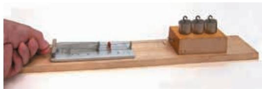
图 3-3-1 探究滑动摩擦力大小的实验
