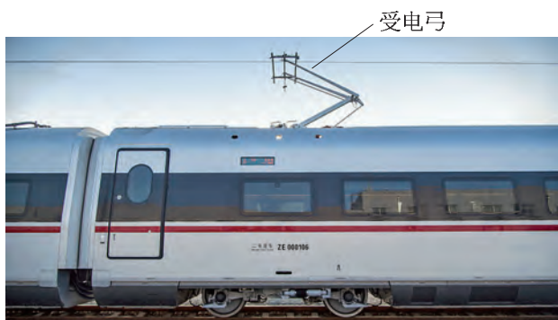
图 7-1 高铁上方的受电弓从接触线获取电能
