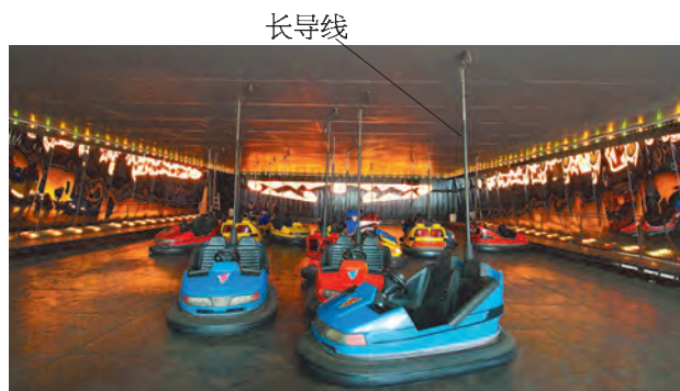
图 7-2 碰碰车通过尾部的竖直长导线获取电能
