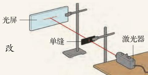
图 4-28 单缝衍射实验装置图
