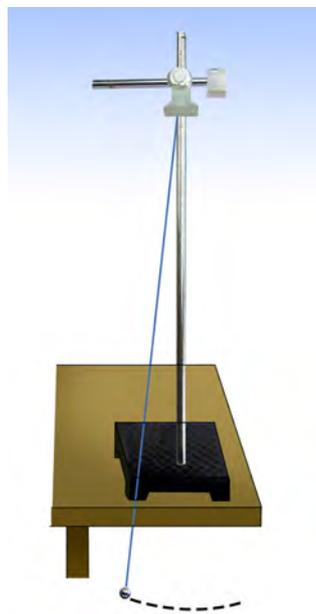
图 2-21 用单摆测量重力加速度的实验装置
