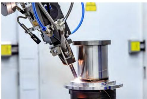
图 4-47 激光焊接金属
