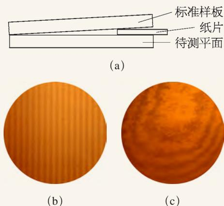
图 4-25 干涉检测物体表面平整度
