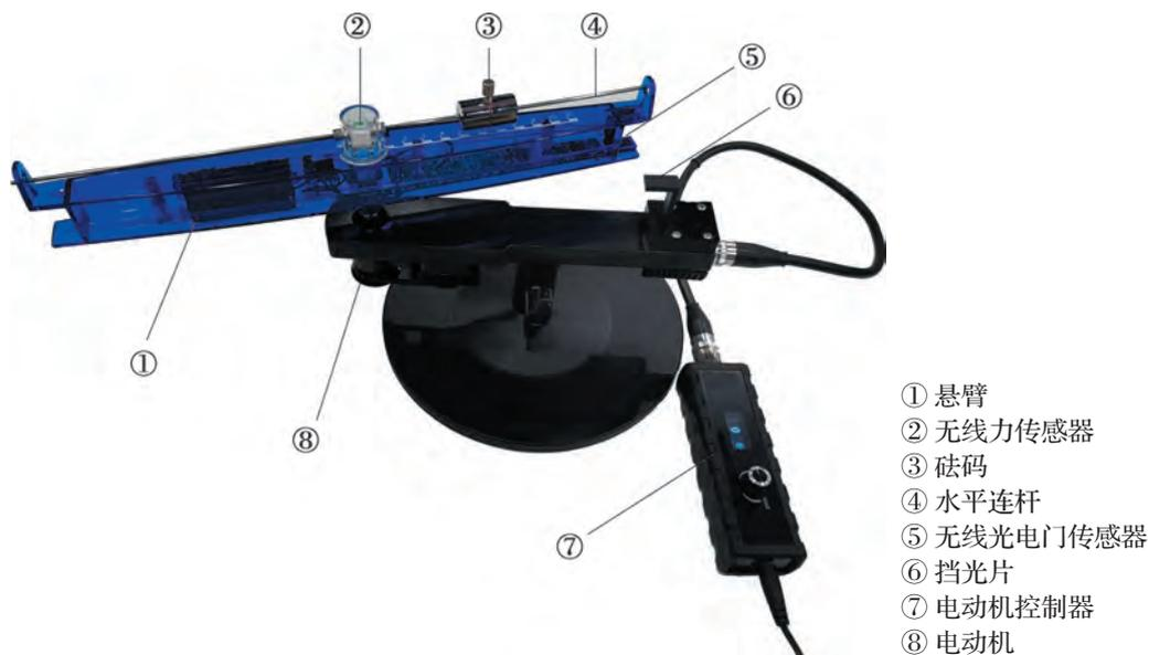
图 5-36 研究向心力的实验装置
