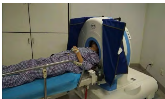
图 11-39 稀土材料小型 16 层移动 X-CT
