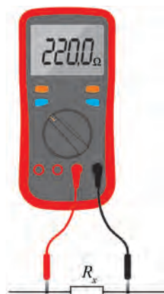
图 10-34 用数字式多用电表测电阻
