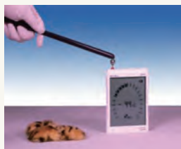
图 9-7 用数字式静电计检测物体所带的电荷量
