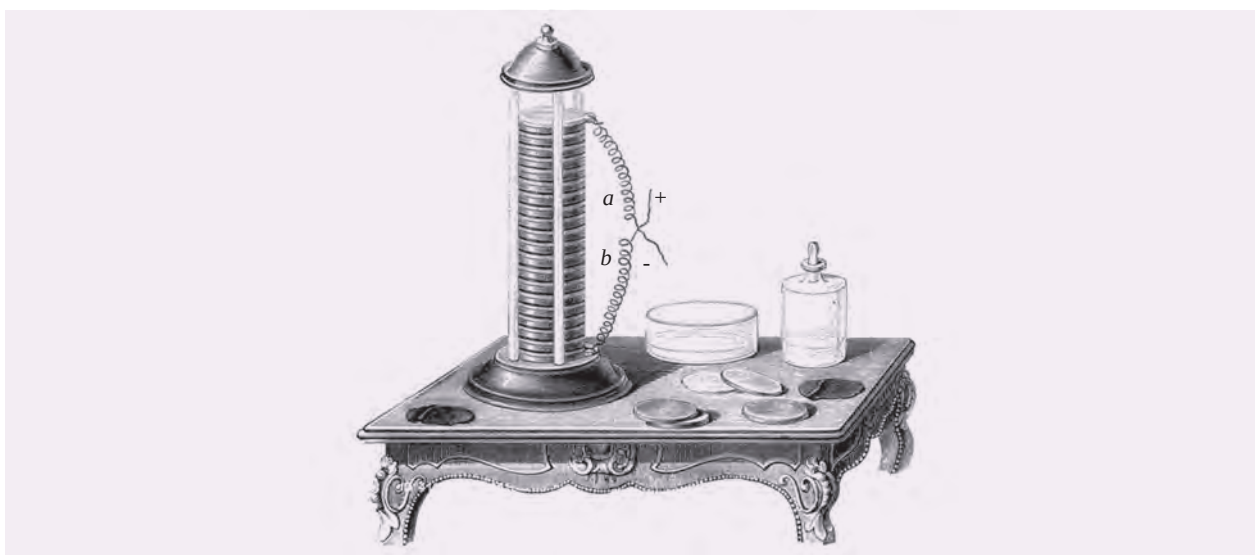
图 10-41 由银片、锌片和浸湿的布叠合而成的伏打电堆
