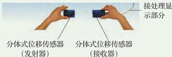
图 1-11 用传感器测量位移的大小
